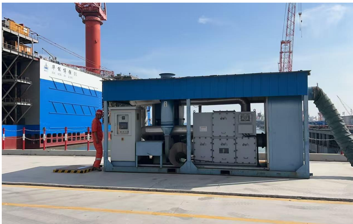
图 9.1-2 沸石转轮+CO 催化燃烧移动废气处理设备
