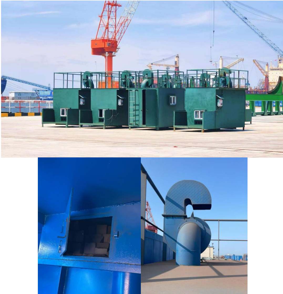
图 9.1-3 密闭式移动调漆房
