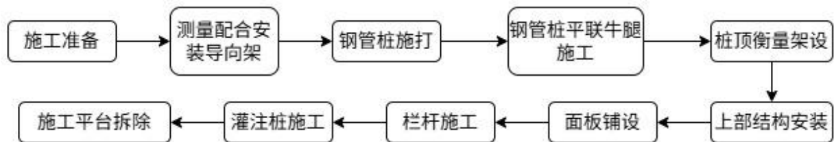
图 3.2-7 施工平台搭设施工过程图
