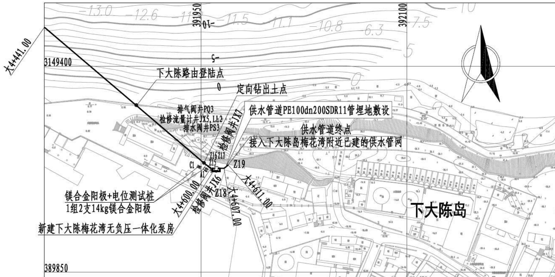
图 3.3-11 项目管道定向钻穿越出土段平面布置图
